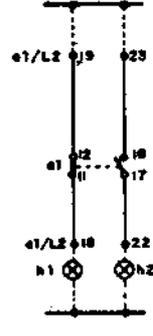
Contato auxiliar Y6 no pêndulo
