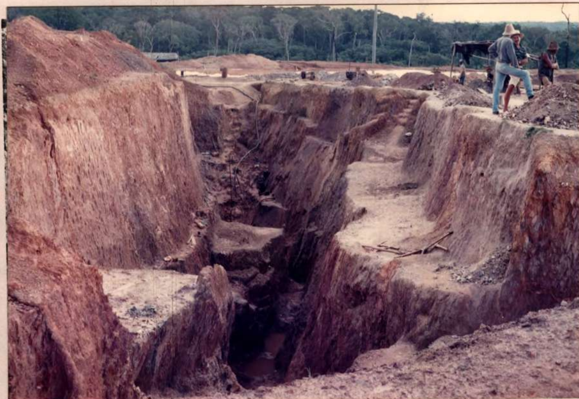
Foto 02 - Filão do Fabinho - Aspecto geral da cava aberta ao longo corpo mineralizado com atitude N50E/75SE, espessura de cerca de 1,8 m, encaixado em quartzo-xisto.
