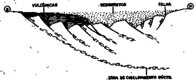
Figura 4 - Seção esquemática ilustrando a geometria da bacia que acolheu as rochas vulcânicas Surumu e os sedimentos Roraima no Compartimento Ocidental em Roraima. Modificado de Costa et al. (1991b)
